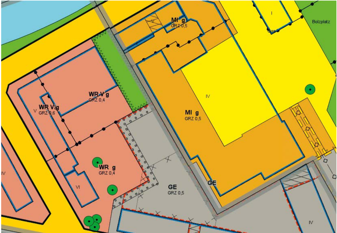
Abbildung 22: visualisierter Vektordatenbestand (XPlanung-konform)
